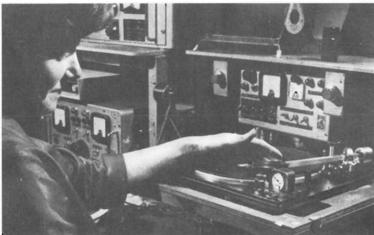
Fig. 8.10 Il controllo delle specifiche di un giradischi non può essere fatto in modo appropriato se non con una strumentazione sofisticata come quella utilizzata su questo banco di prova della Garrard.
