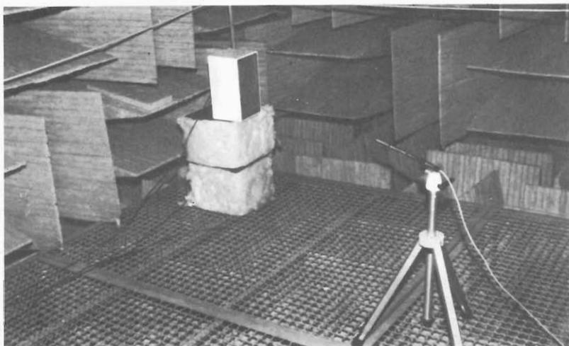
Fig. 6.5 I diffusori vengono provati in camere anecoiche ben « imbottite » allo scopo di evitare riflessioni sonori. Qui viene provata una DM 70 della Bowers e Wilkins.
