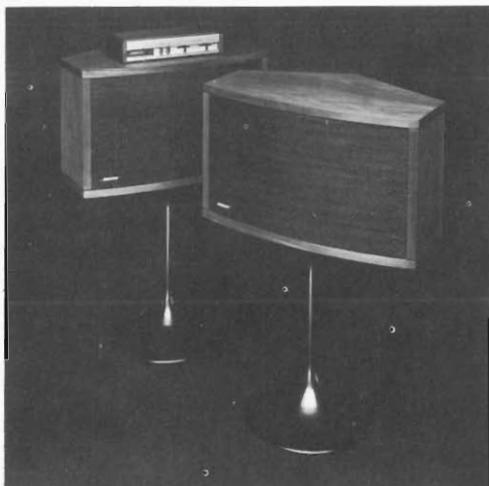
Fig. 6.16 Alzatelo da terra! Il contatto diretto della cassa con il pavimento contribuisce a creare dei falsi bassi per via dell'esteso diaframma fittizio che si viene a formare. I migliori diffusori monitor vengono progettati per essere fissati al muro o per essere sistemati su dei sostegni come questo diffusore Ferrograph.
