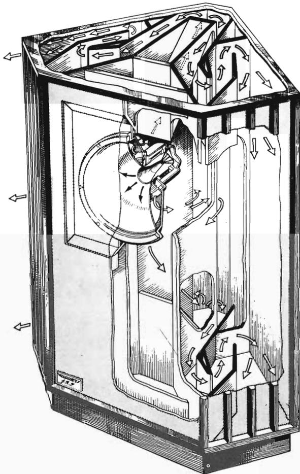
Fig. 6.13 Spaccato assometrico del diffusore Tannoy GRF a tromba caricata. Il percorso dell'aria (ovvero del flusso sonoro) è indicato dalle freccette.
