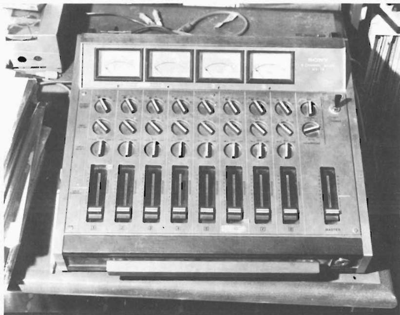
Fig. 7.12 (sopra): Un semplice miscelatore stereofonico alla portata dell'amatore, col quale è possibile combinare segnali provenienti da giradischi, radio microfono, con il bilanciamento complessivo. (sotto): Una console di miscelazione professionale, azionata da ingegneri/musicisti, che permette di elaborare il suono che vi arriva nei modi più disparati.
